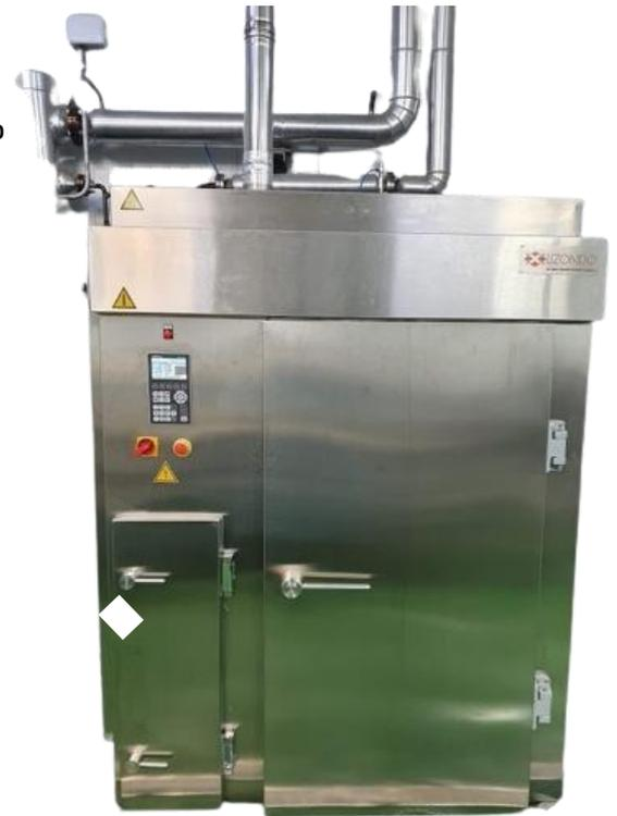
El horno está construido en módulos: delantero, trasero y base, soportados por una estructura tubular forrada con paneles INOX y con aislamiento térmico en el interior.
