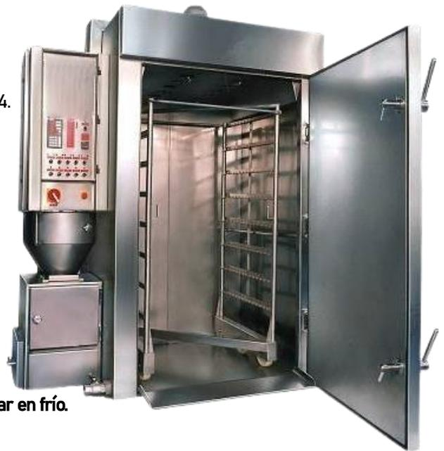
El horno está construido en módulos: delantero, trasero y base, soportados por una estructura tubular forrada con paneles INOX y con aislamiento térmico en el interior.
